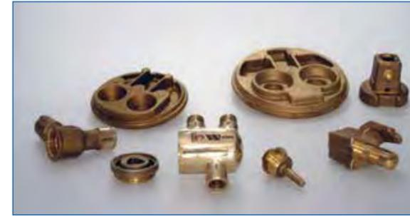
Es kommt auf das Schmieden eines Stückes Messing, zuvor bei einer Temperatur von 600 bis 750 °C beheizt, je nach Art des Messings. Dieser Vorgang erfolgt auf einer Presse, ausgestattet mit einem Werkzeug, gefertigt nach der allgemeinen Form des Stückes zu erhalten. Dann kann das Schmiedestück, um das gewünschte Teil zu bekommen, bearbeitet werden.
